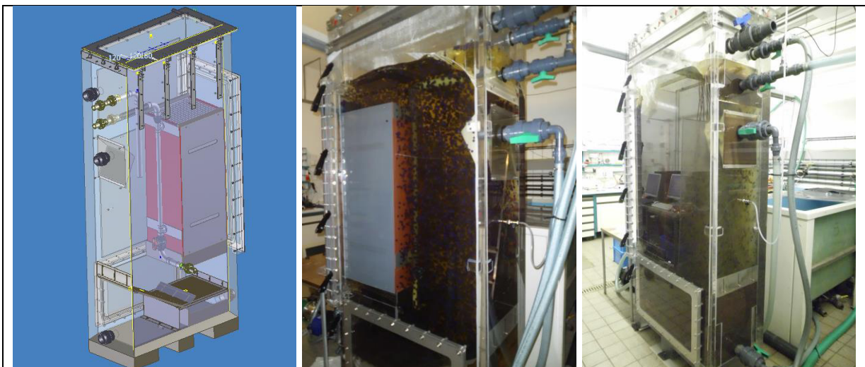
Abb. 7: MDR, li: CAD-Konstruktion, Mitte: Foto, Start des Reaktors, re: Versuchende
