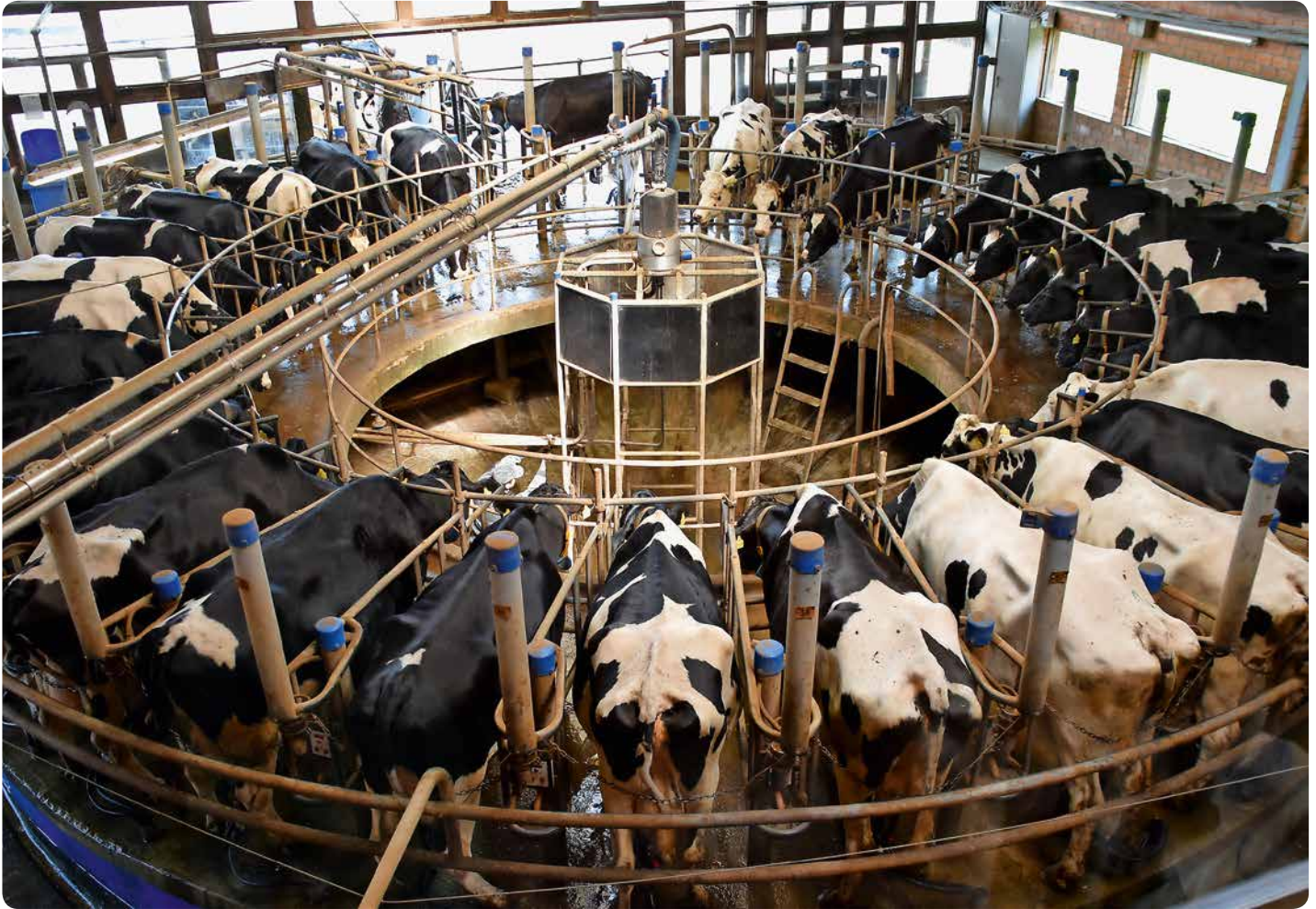
Fällt der Strom aus, funktioniert auch das Melkkarussell nicht mehr. Auf Betrieben mit hohen Tierzahlen ist das Melken per Hand keine Alternative. Foto: Sonja von Brethorst
