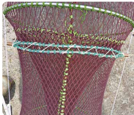
Die Reißnaht ist eine von zwei möglichen Notausstiegen: Flexible Drahtseile werden mit einem Latexband zusammengehalten. Foto: Anja Reckendorf
