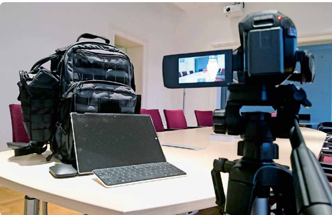
Mobile Aufzeichnungseinheit: Der Rucksack enthält alle nötigen Kabel, eine digitale Videokamera, ein Mikrophon sowie ein Tablet mit einer Multimedia-Aufzeichnungssoftware für Windows. Foto: C. Kleinsorgen
